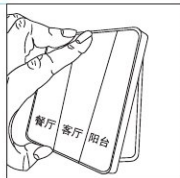
5) 逐个扣上按键面板(请务必在断电状态下扣按键面板)
